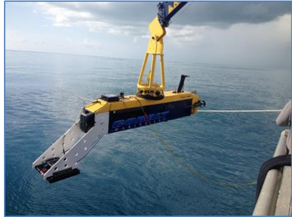
HAUV Dolores with Gen-1 EM array
