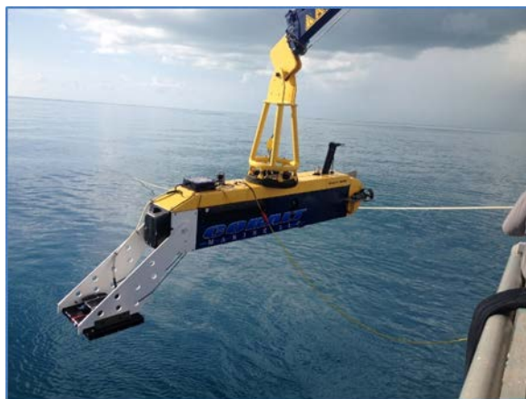
HAUV Dolores with Gen-1 EM array
